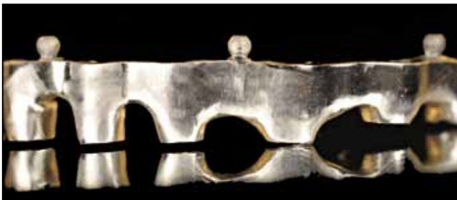
Fig. 30 Struttura dopo aver tagliato i perni accessori di colata dopo prima rifinitura. Più sarà alta la qualità della fusione, più saranno precise le sfere degli attacchi. Molto importante sarà valutare l'esatta espansione del rivestimento e l'utilizzo di frese adeguate per la rifinitura e lucidatura delle sfere per non perdere il diametro delle stesse
