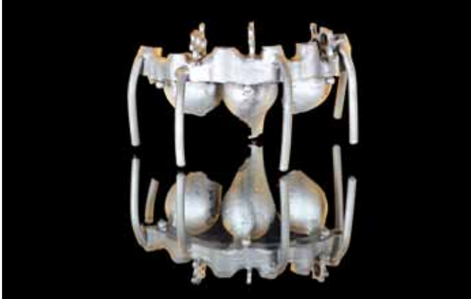
Figg. 28 e 29 Fusione appena estratta dal rivestimento
