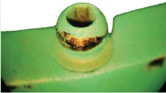
▲ fot. 24 i 25. Mikroskop – obszary aktywności zatrząsków; istnieją punkty, które blokują prawidłowe osadzenie
