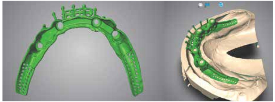
Fig 21. Design de la contre-barre aussi mince que possible.
