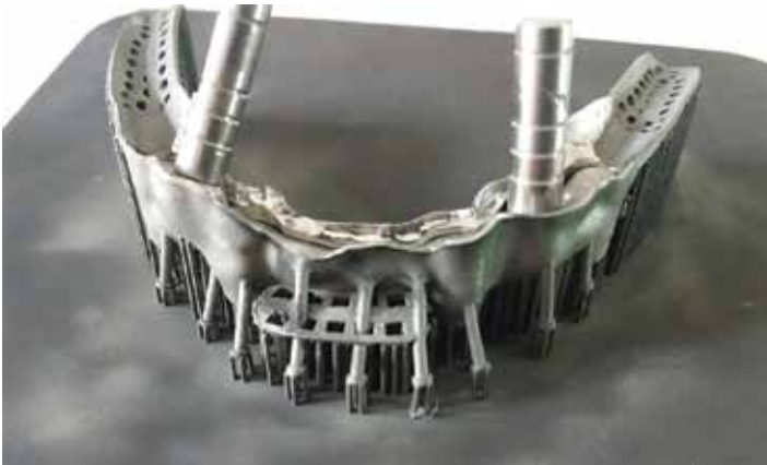
Fig 22. Détail de la contre-barre obtenue par un procédé de fusion par laser.
