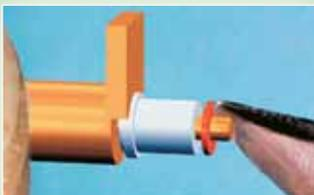
Postavite keramički čuvar prostora i livni prsten na kalup kućišta.
