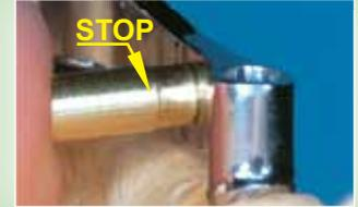
Ubacite kalup kućišta u rupu i zaključajte u toj poziciji akrilatom.. budite oprezni da ne predjete „STOP“ kada nalivate akrilat.
