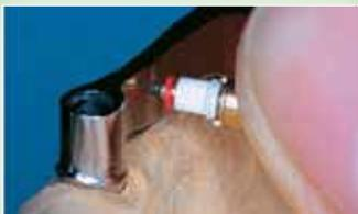
Ubacite kućište u rupu na prečki i osigurajte akrilatom.
