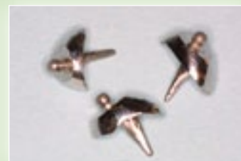
Izliveni kolčići sa kuglami. Moguće je da kugle nisu postavljene okomito na osnovu kolčića.
