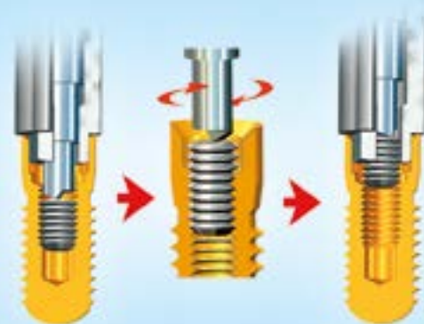
SLOMLJENI VIJAK U FAZI IZVLAČENJA
