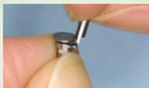
Courber la clé de blocage jusqu'à ce qu'elle se brise sur le point de cassure.
