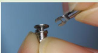
Assembler le verrou et insérer la clé de blocage avec le point de cassure dans son logement.
