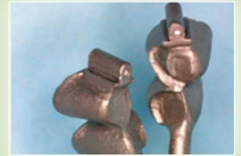
Sabler la partie coulée et éliminer le pin de céramique avec une foret de diamètre approprié.
