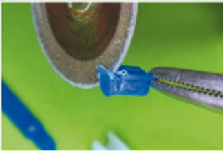
L'attachement et le clip peuvent être montés entiers (5 mm) ou coupés (3.5 mm).
