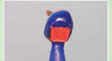
Döküme hazır kayar taban ve modelajı tamamlanmış şapka
