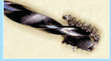
Mikromotor devri 2000 devir/ dakika'nın altına düşmemelidir.
