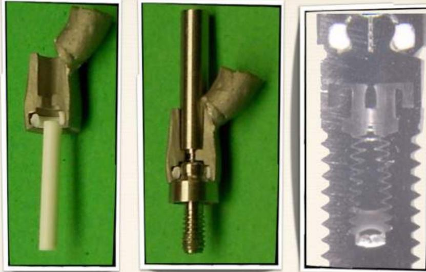
CP1 - Fig. 77-78-79: La microfotografia della sezione della connessione (Impianto - Biologic Abutment Equator - Moncone Protesico) spiega le peculiarità di questo ancoraggio composto dalla molla seeger + la vite protesica. Si noti come l'interno del pilastro sia completamente passivo consentendo il contatto solo sul bordo di chiusura del moncone e, a livello sotto-equatoriale, sulla molla seeger (che si vede in sezione di colore bianco).
