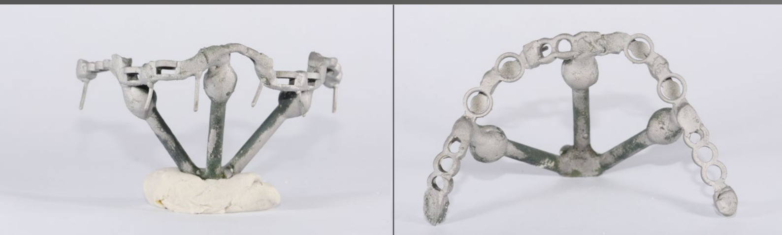
38 & 39 Das aus einer CoCr-Legierung gegossene Gerüst vor dem Abtrennen der Gusskanäle
