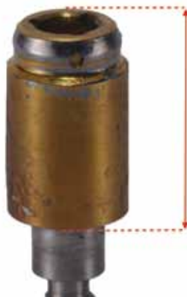
Fig. 6 Usura dell'abutment a basso profilo a causa di un errato asse di inserzione protesico per eccessivo disparallelismo con conseguente usura precoce degli attacchi e mancanza di ritenzione protesica. L'eccessiva altezza dell'abutment causa un sovraccarico a livello implantare
