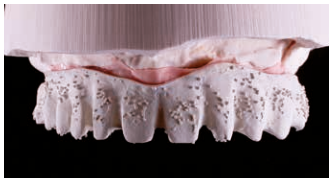
Рис. 15. Супраструктура из ПЭЭК (полиэфирэфиркетона)
