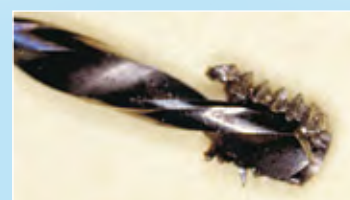
VITE ROTTA IN FASE DI RIMOZIONE
