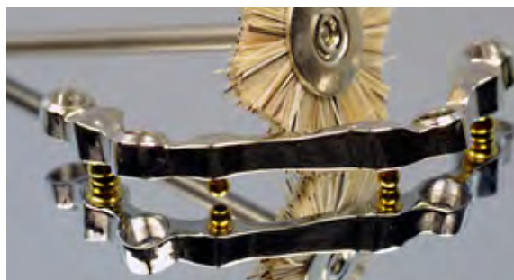
Levigatura e pre-lucidatura connessioni
