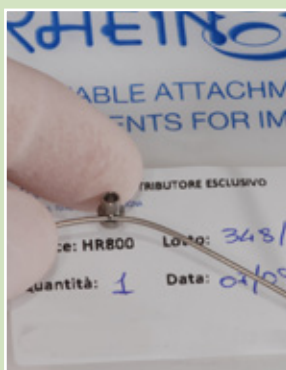
Filo in titanio inserito all'interno di un foro del moncone passante del diametro di 1mm.
