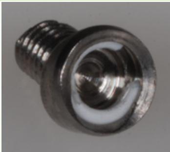
Moncone Extragrade in Titanio con foro, inclinato di 15°. Il Seeger bianco va inserito con l'apertura nella direzione del sottosquadro.
