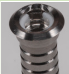
Il Seeger deve avere la parte aperta anche essa dal lato divergente, posizione che viene resa obbligata da un gradino anti-rotazionale che si trova all'interno della gola.
