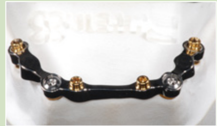
2 Ot Equator filettati per cad cam e 2 Ot Equator seeger in posizione, in caso di divergenza (gli Ot Equator seeger seguono la direzione degli impianti) è suggerito l'uso dei contenitori Smart box.
