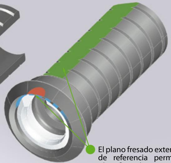
El plano fresado externo de referencia permite identificar la posición interna del ensanchamiento extragrade.
