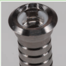
Το άνοιγμα του δακτύλιου Seeger τοποθετείται προς την επίπεδη πλευρά του κολοβώματος. Μία θέση που χάρη στην λοξοτομή εμποδίζει την περιστροφή του δακτύλιου μέσα στο κολόβωμα.
