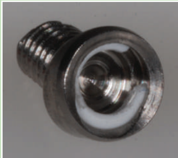
Κεκλιμένα κολοβώματα τιτανίου 15°. Ο λευκός δακτύλιος Seeger τοποθετείται με το άνοιγμα του προς την κλίση του εμφυτεύματος.
