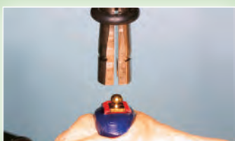
Τοποθετήστε την σφαίρα με την βάση παράλληλα. Μόνο οι τρεις πλευρές της βάσης πρέπει να καλυφθούν.
