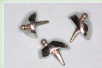
Χυτεύστε τον άξονα και σφαίρα. Είναι δυνατόν η σφαίρα να μην τοποθετηθεί στο κέντρο του άξονα.
