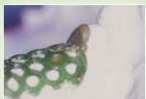
Modello duplicato in rivestimento e base d'appoggio modellata
