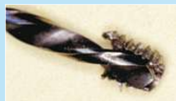
VITE ROTTA IN FASE DI RIMOZIONE
