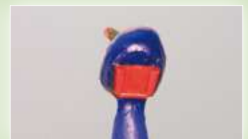
Cappette con base guida calcinabile pernate e pronte per la messa in rivestimento
