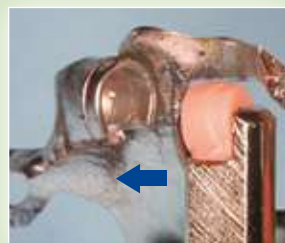
Inserzione della cappetta nel contenitore INOX in senso laterale
