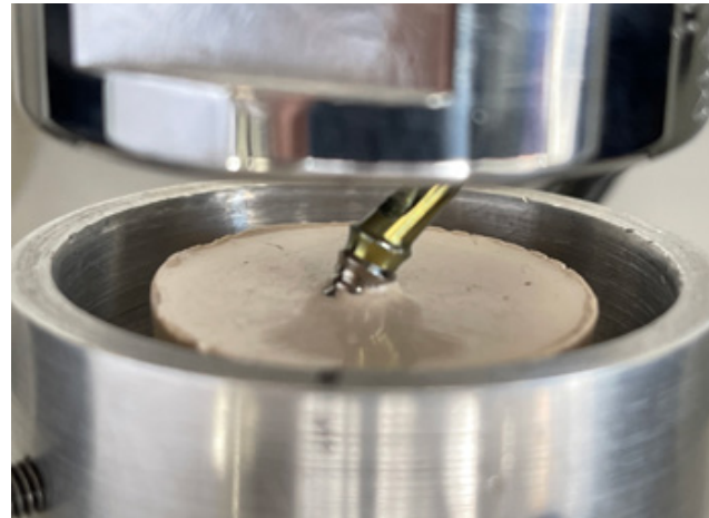
Fig. 26. → Fractura del tornillo en el interior del implante.
