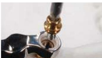
Inserzione dell' Ot Equator seeger all'interno dell'anello autoestraente in peek già in posizione.
