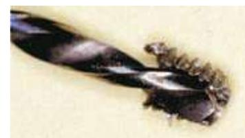
Vite rotta in fase di rimozione
