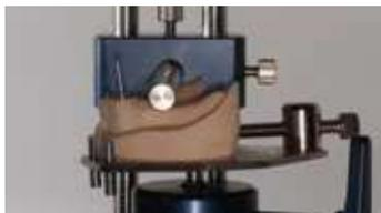
Analisi del modello mediante il Parallelometro Rhein83
