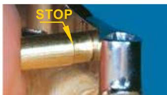
Inserire il posizionatore in ottone nel foro e fermarlo. Lo STOP corrisponde al volume corretto del contenitore prefabbricato.
