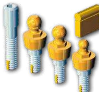
Costruito in materiale inerte e biocompatibile. Si autofiletta durante l'avvitamento. A fine corsa la sua memoria elastica si espande e tende a riprendere la forma iniziale, frenando le sollecitazioni che portano allo svitamento degli abutment.
