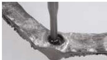
Broca especial utilizada para limpar o óxido ou quaisquer pequenas bolhas no interior do pilar fundido.
