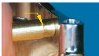
Introduzir o posicionador de latão no orifício e bloqueá-lo. O STOP corresponde ao volume correto do encaixe pré-fabricado.
