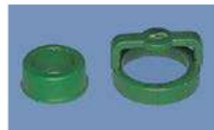
Anel posicionador a ser inserido na esfera antes de duplicar o modelo em revestimento e encaixe calcinável
