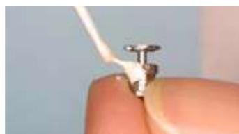
Aplicar o material compósito auto-endurecedor para fixar a chave de bloqueio e introduzir o pino deslizante no orifício.
