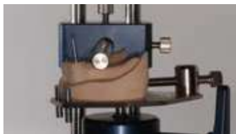
Анализ моделей с использованием параллелографа от Rhein83.
