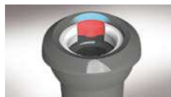
Seeger также должен быть открыт на стороне расхождения, что обусловлено антивращательным выступом внутри отверстия.
