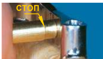
Вставить позиционер из латуни в отверстие и зафиксировать. Пункт остановки СТОП соответствует объему готового контейнера.
