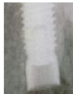
Ακτινογραφία του σπασμένου τμήματος της βίδας
